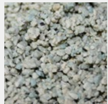
Filtersubstrat gem. ÖWAV Regelblatt 45 und Ö-Norm B2506-3
